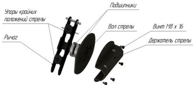
Рисунок 6.2.1. Узел крепления и управления стрелой
