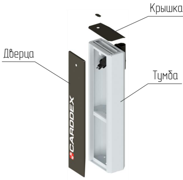
Рисунок 6.1.1. Внешний вид и состав корпуса шлагбаума.
